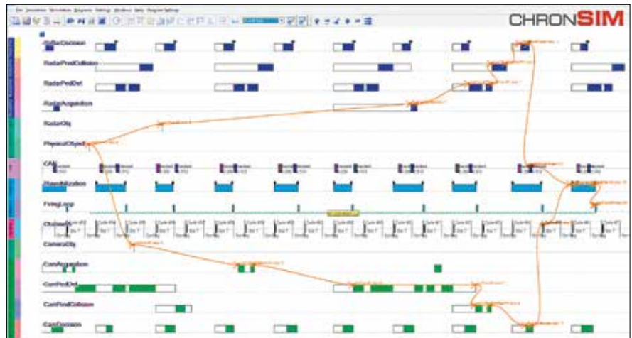
Bild 2: Analyse der Radar- und Kamerawirkkette für die Variante „Dedizierte ECUs“ einschließlich der Plausibilisierung mit dem Echtzeitsimulator chronSIM.
