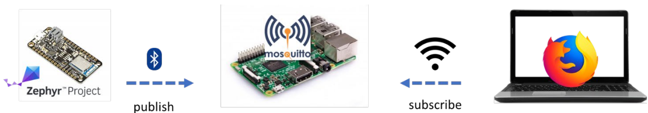
Abbildung 1: Schematischer Aufbau unserer "IoT-Solution"
